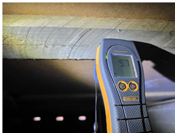
Fuktkvoten uppmättes i blindbottenstöd till 10% vilket är under kritisk gräns för mikrobiell tillväxt.
