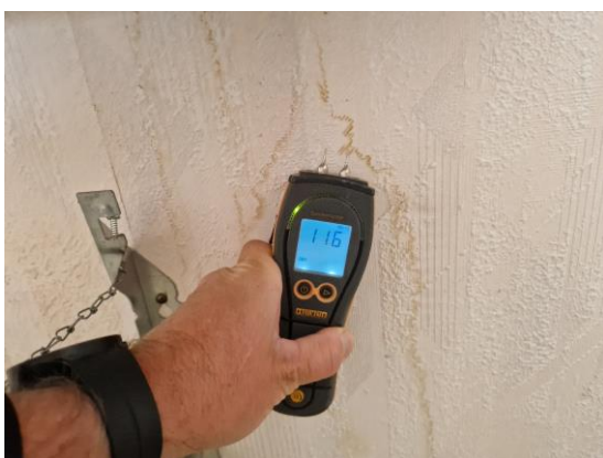
Fuktindikering utfördes på fuktfläckar i trapphus utan avvikelser.
