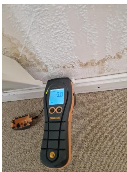
Fuktindikering utfördes på fuktfläckar i trapphus utan avvikelser.
